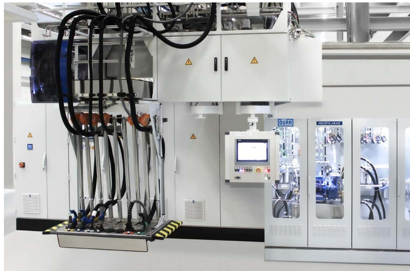
Kombinierte Befüllung aller Medien mit einer ProLine Befüllanlage
