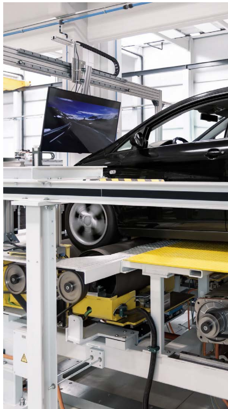
Der x-road curve simuliert mittels Bildschirm reale Fahrsituationen
