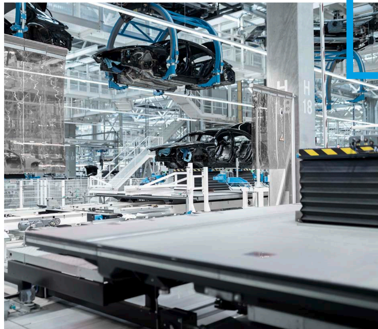
Schubplattform mit integriertem Hubtisch (rechts unten) und Schwerlast-EHB mit integrierter Hubschere (Mitte oben) in Produktionsumgebung
